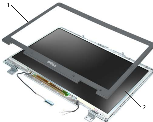
1 cornice dello schermo 2 pannello dello schermo
